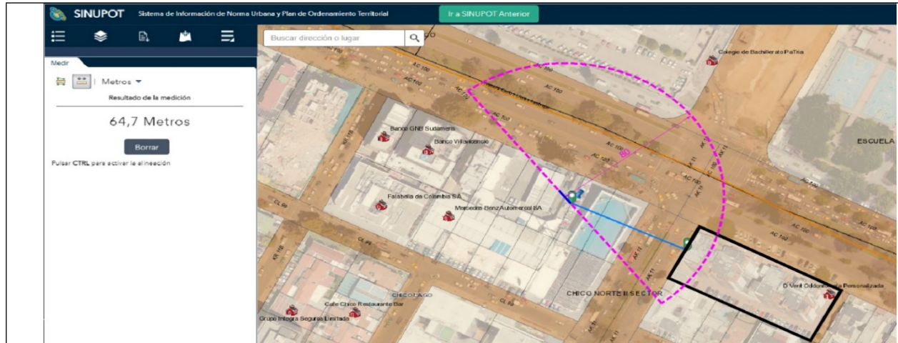
Foto 1. Vista en planta de la afectación lumínica del elemento PEV con innovación tecnológica ubicado en la Av. Calle 100 No. 11 - 41 (dirección catastral), orientación ESTE - OESTE , a la edificación residencial con nomenclatura Av. Calle 100 No. 10 - 25 donde se evidencia que hay una distancia menor de ochenta (80) metros medidos por el frente de la valla, en un ángulo hasta de ciento ochenta grados (180°).
